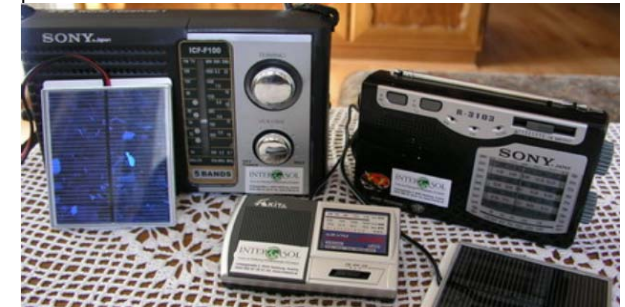
Beispiele für Solarradios: Es handelt sich um konventionelle Radios, die in Oruro, Bolivien, umgebaut und mit Solarmodulen aufgeladen werden. Dank der Expertise von Ing. Walter Zöhling (EPS Soltec) und Sigi Popp (Solarprojekt Freilassing e.V.) werden seit 2009 auch Solarmodule in Oruro produziert.
